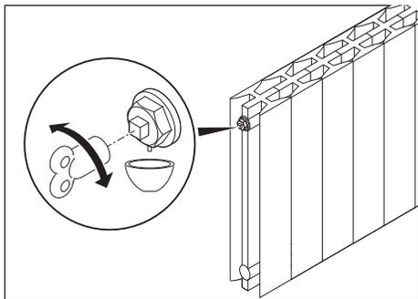
4. Purgez tous les radiateurs au niveau du raccord prévu à cet effet (en haut du radiateur, à gauche ou à droite).
